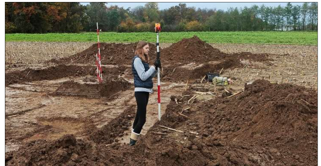
Miriam Öttl hilft beim Vermessen der Grabung mit Tachymat und Reflektor
